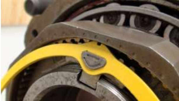
Retainer Tab Entering Groove in Nut.
