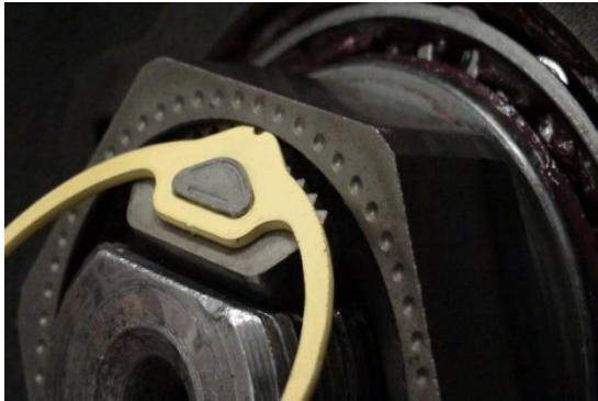
Retainer Tab entering groove (FF Style).
