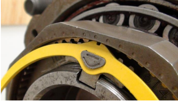
Retainer Tab Entering Groove in Nut.
